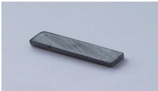
Рисунок 8 – спрессованный и спеченный образец.
